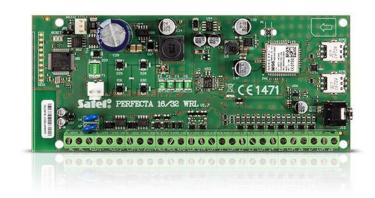
commande par SMS et vérification audio (écoute des sons des locaux protégés). Deux cartes nano-SIM gérées assurent la communication continue, en cas de problèmes avec le port du premier opérateur, la deuxième carte est automatiquement sélectionnée.
