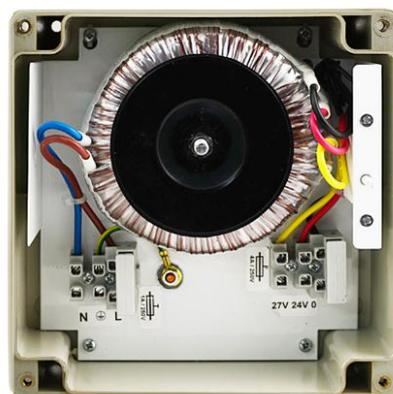
La PU-IP65-24VAC-1X1A0 est une alimentation AC/AC délivrant une tension de 24 ou 27 VAC et un courant maximal de 4A (@24 VAC). La tension de sortie est ajustable à l'aide de cavaliers. L'alimentation est logée dans un boîtier ABS avec micro-interrupteur pour indiquer l'ouverture de la porte.
