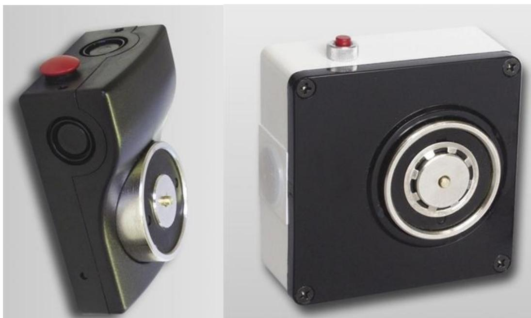
Les aimants de portes CSA maintiennent les portes ignifuges ouvertes pendant leur utilisation normale. En cas d'alarme incendie, les portes sont déverrouillées et fermées par une pompe, ce qui assure la résistance au feu du compartiment. Les aimants sont fréquemment utilisés dans des hôpitaux, maisons de repos, immeubles de bureaux, hôtels, écoles... où des portes ignifuges sont généralement présentes.
