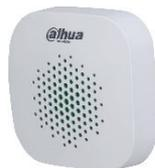
Sirène intérieure sans fil. • 2 tonalités sirène (medium & high) • Puissance acoustique: 84dBA à 1 mètre (mode HIGH) / 78dBA à 1 mètre (mode MEDIUM) • Dimensions (lxhxp): 81x81x26 mm • 2 fois pile CR123A incluse ! A utiliser en combinaison avec le système Dahua ALARM HUB2.
