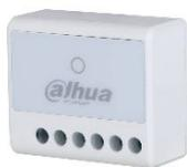
Module de sortie à relais sans fil, capacité de commutation à basse tension. • Sortie relais NO/NG contrôlable (capacité de commutation 0-36Vcc, Max 5A) • Entrée pour la surveillance d'un contact d'autoprotection (NO ou NF) • Protection contre la surchauffe • Nécessite une source d'alimentation externe de 7-24Vcc • Dimensions (lxhxp): 39x33x19 mm ! A utiliser en combinaison avec le système Dahua ALARM HUB2.
