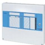
Centrale incendie conventionnelle 2 zones, 2 entrées programmables. Class change, fonction jour/nuit, alerte et évacuation. Dimensions: 356mm x 318mm x 96mm. Espace pour 2 batteries 12V 7Ah. La centrale est agréée BOSEC avec les détecteurs de la série ECO1000.
