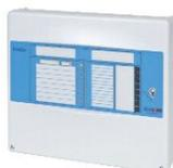
Centrale incendie conventionnelle 4 zones, 2 entrées programmables. Class change, fonction jour/nuit, alerte et évacuation. Dimensions: 356mm x 318mm x 96mm. Espace pour 2 batteries 12V 7Ah. La centrale est agréée BOSEC avec les détecteurs de la série ECO1000.
