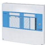
Centrale incendie conventionnelle 8 zones, 2 entrées programmables. Class change, fonction jour/nuit, alerte et évacuation. Dimensions: 356mm x 318mm x 96mm. Espace pour 2 batteries 12V 7Ah. La centrale est agréée BOSEC avec les détecteurs de la série ECO1000.
