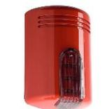
Sirène extérieure rouge autonome en ABS avec flash led rouge sur 24 VDC, conforme EN54-3, pression sonore 102 dBA à 1 m. 24V nominal, courant de charge max 0,5A. Dimensions H322 x L215 x P105mm.
