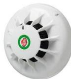
**701H Détecteur TVC 60°** • **CARACTÉRISTIQUES** : • EN54 Approuvé par le LPCB • Basse tension de fonctionnement : 10,5 Vdc à 33 Vdc • Esthétiquement discret • Des performances et une fiabilité supérieures • Conçu pour une installation rapide • LED d'alarme intégrée • Connexion pour LED distante • Câblage indépendant de la polarité • Compatible avec le socle de montage standard et avec le socle de relais
