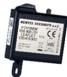
Le mini module d'entrée adressable FC410MIM est conçu pour surveiller un équipement externe. Le FC410MIM fournit une entrée qui peut être configurée en normalement ouverte ou normalement fermée. • CARACTÉRISTIQUES : • EN54-13 avec les centrales incendies de la série FC50x • Dimensions (LxHxP) : 48x57x13 mm • Température de fonctionnement : -25 à 70 °C • Température de stockage : -40 à 80 °C • Humidité relative : 95% (sans condensation)
