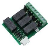
Platine avec 4 sorties relais pour centrale FPC-500-4 et -8.
