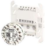
Module interface LSNi pour centrales incendie analogique de Bosch. Ce module a une sortie transistorisée OC et une entrée supervisée Isolateurs de court-circuit intégrés. Encastrement sans boîtier IP30. Conforme EN54-18 et EN54-17.
