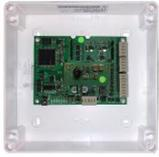
• Module de bus périphérique de pompiers en anneau pour FPA-5000/1200/1100 • Interface TTY/MTS-4A pour la connexion au module IOS 0020 A ou FPE-5000-UGM • Protocole commun pour les périphériques FBF et FAT • Interface ESPA (en option)
