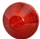
Flash rouge LSNi pour centrales incendie analogiques Bosch pour signalisation, pas pour évacuation. Isolateurs de court-circuit intégrés. Synchronisé à 1Hz. Montage sur socle MS 400 ou FNM-420-A-BS.
