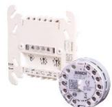
Module interface LSNi pour centrales incendie analogiques de Bosch. Ce module a un contact relais inverseur (30VDC 5A) pour la commande de coupoles de fumée, portes incendie, ascenseurs... Isolateurs de court-circuit intégrés. Montage rail DIN IP30. Conforme EN54-18 et EN54-17.
