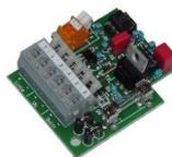
Module pour réinitialiser un détecteur conventionnel FCS-320-TP1, -TP2 ou -TM.
