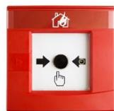
• L'alarme incendie manuelle sans fil peut être montée n'importe où dans une cellule radio. • L'alarme incendie manuelle sans fil se compose d'un boîtier et d'une unité de commutation avec électronique radio et antenne bi-bande. • Activation indirecte de l'alarme en brisant l'insert en verre et en appuyant sur le bouton d'alarme. • Un capuchon de protection (accessoires) protège l'alarme incendie portable contre le bris involontaire du verre.
