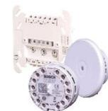
Module interface LSNi pour centrales incendie analogique de Bosch. Ce module a deux entrées supervisées. Isolateurs de court-circuit intégrés. Montage mural avec couvercle IP30. Conforme EN54-18 et EN54-17.
