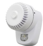
Sirène Roshni blanc avec flash led blanc pour montage mural, 32 tonalités, 102dB, 18-28VDC, 22-37 mA, IP65, conforme EN54-3 et EN54-23, couverture flash W-2,4-7,5, fréquence 0,5 ou 1 Hz, L95mm x H135mm x P95mm.
