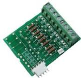
Platine avec 4 sorties OC pour centrale FPC-500-4 et -8.
