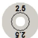
Autocollant avec trou de détection de 2,5 mm de diamètre.
