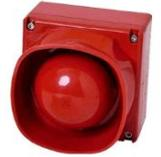
Sirène rouge LSNI analogique adressable. Isolateurs de court-circuit intégrés. 32 différentes tonalités et volume réglable jusque 100dB(A). Consommation max 3,9mA. IP66. Synchronisation automatique. Conforme EN54-3 et EN54-17.
