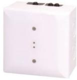
Module interface LSNi pour centrales incendie analogiques de Bosch. Ce module a deux zones conventionnelles supervisées pour le raccordement de détecteurs incendie conventionnels tels que détecteurs beam, de flamme ou détecteurs conventionnels existants. Isolateurs de court-circuit intégrés. Indication LED. Boîtier apparent IP54. Conforme EN54-18 et EN54-17.
