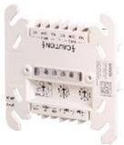
Module interface LSNi pour centrales incendie analogiques de Bosch. Ce module a deux contacts relais inverseur (230VAC 10A) et deux entrées pour la commande de coupoles de fumée, ventilateurs, portes incendie, ascenseurs... Isolateurs de court-circuit intégrés. Indication LED. Boîtier apparent IP54. Conforme EN54-18 et EN54-17.
