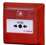
Bouton poussoir rouge LSNi pour centrales incendie analogiques de Bosch. Isolateurs de court-circuit intégrés. Vitre incassable. Indication LED. Semi-encasté. Montage intérieur IP54. Conforme EN54-11.
