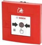
Bouton poussoir rouge LSNi pour centrales incendie analogiques de Bosch. Isolateurs de court-circuit intégrés. Indication LED. Montage intérieur IP52. D'abord briser la vitre et confirmer en appuyant sur le bouton. Conforme EN54-11.
