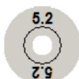
Autocollant avec trou de détection de 5,2 mm de diamètre.
