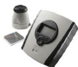
Détecteur de fumée conventionnel Beam IR. Contrôleur séparé avec clavier, écran LCD et LED's d'état. 1 FRAY5000-HEAD-EN (émetteur-récepteur et réflecteur) inclus, extensible jusqu'à 2 émetteurs-récepteurs. Sensibilité réglable. Relais alarme & défaut pour chaque émetteur-récepteur. Alimentation 14-28Vc.c. Certifié BOSEC.
