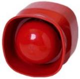
Sirène rouge LSNI analogique adressable. Isolateurs de court-circuit intégrés. 32 différentes tonalités et volume réglable jusque 100dB(A). Consommation max 3,9mA. IP42. Synchronisation automatique. Conforme EN54-3 et EN54-17.
