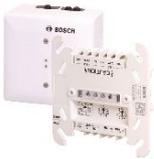
Module interface LSNi pour centrales incendie analogiques de Bosch. Ce module a deux contacts relais inverseur (230VAC 10A) et deux entrées pour la commande de coupoles de fumée, ventilateurs, portes incendie, ascenseurs... Isolateurs de court-circuit intégrés. Indication LED. Montage rail DIN IP30. Conforme EN54-18 et EN54-17.
