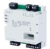
• Module avec 2 entrées et 1 sortie surveillée • Contrôle surveillé des dispositifs de signalisation par inversion • Affichage LED pour l'indication de l'état • Données de diagnostic pour faciliter la maintenance • Montage en surface ou sur rail DIN
