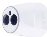
• Détecteur de faisceau avec réflecteur • Portée de détection jusqu'à 50 m et pouvant être étendue à 120 m avec des réflecteurs d'extension • Possibilité de liaison avec le contrôleur Fireray Hub • Température de fonctionnement : -20 à +55°C • IP55
