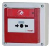
Bouton poussoir rouge LSNi pour centrales incendie analogiques de Bosch. Isolateurs de court-circuit intégrés. Vitre incassable. Indication LED. Boîtier apparent inclus. Montage extérieur IP67. Conforme EN54-11.
