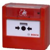
Bouton poussoir rouge LSNi pour centrales incendie analogiques de Bosch. Isolateurs de court-circuit intégrés. Vitre incassable. Indication LED. Boîtier apparent inclus. Montage intérieur IP54. Conforme EN54-11.
