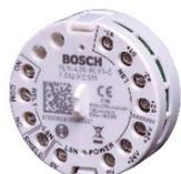
Module interface LSNi pour centrales incendie analogiques de Bosch. Ce module a un contact relais inverseur (30VDC 1A) pour la commande de coupoles de fumée, portes incendie, ascenseurs... Isolateurs de court-circuit intégrés. Encastrement sans boîtier IP30. Conforme EN54-18 et EN54-17.
