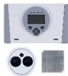
• Kit comprenant 1 détecteur de faisceau, 1 contrôleur central et 1 réflecteur • Portée de détection jusqu'à 50 m et pouvant être étendue à 120 m avec des réflecteurs d'extension • Alignement automatique possible sur le contrôleur • Température de fonctionnement : -20 à +55°C • Indice de protection : IP65 (contrôleur du système) IP55 (détecteur de faisceau)
