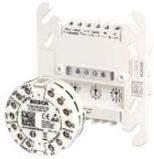
Module interface LSNi pour centrales incendie analogiques de Bosch. Ce module a une sortie transistorisée OC et une entrée supervisée. Isolateurs de court-circuit intégrés. Montage rail DIN IP30. Conforme EN54-18 et EN54-17.
