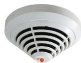
Détecteur optique de gaine LSNi pour centrales incendie analogique Bosch. Isolateurs de court-circuit intégrés, compensation de dérive, analyse intelligente de détection incendie et de dérangement. Convient pour les gaines d'aération avec des vitesses de vent de 1,5m/s jusque 20m/s. Fonctionne avec chambre d'aération FAD-420-HS-EN.
