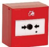
Bouton poussoir sans fil • Certifié par une tierce partie • Communication sans fil bidirectionnelle • Réinitialisable • Grande visibilité de la condition d'alarme grâce à l'indication par LED • Clé de réarmement • Utilise la technologie standard des piles au lithium à faible coût • Durée de vie de la pile : 5 ans • Haute fiabilité • Approbation par une tierce partie selon EN54-1 et EN54-25
