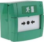
Bouton-poussoir vert, double contact NO/NF, apparent. Intrinsèquement sécurisé. A utiliser avec une barrière Zener MTL 5061.
