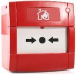
Bouton poussoir d'incendie rouge à sécurité intrinsèque EN54-11 Exia IIC T4 zone 0, 1 & 2 IP24. Fenêtre en plexi incassable. Contact NO avec une résistance série de 470 Ohm pour se connecter aux panneaux d'incendie conventionnels. Fonctionne avec l'isolateur MTL5061. Homologué ATEX BAS00ATEX1245X. Fourni avec un boîtier apparent.
