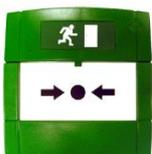
Bouton-poussoir vert avec symbole 'EXIT' Complètement étanche IP67. Boîtier apparent avec 3 entrées de câble inclus. Vitre plexi incassable. Double contact inverseur.
