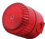
Flash Xénon Solex, Lentille rouge, Base profonde rouge, IP65, 10Cd, 10-60VDC 80mA, D93mm x H94mm.
