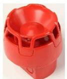
Sirène rouge avec socle profond, 32 tonalités, conforme EN54-3, 103dB, 12-29VDC, 31 mA, IP65, D100mm x H102mm, 235 g, connexion First Fix.
