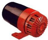
Sirène incendie actionnée par moteur. 230V AC/DC, 120dB à 1m. 1800Hz continu, 1,4A, IP65, fonctionne de -30°C jusque +45°C. Dimensions L180 x H115 x P95mm.
