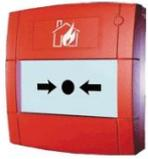
Bouton poussoir incendie rouge EN54-11. • Agréé BOSEC avec les centrales incendie HRZx et VSNx-2Plus • Vitre plexi incassable. • Contact NO avec une résistance série de 470 Ohms • Pour raccordement sur centrales incendie conventionnelles FP10x-PA, XFC, VSNx 2Plus et HRZx.
