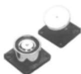
Electro-aimant 24VDC, 100kg, avec diode, 100 mA, sans bouton de déblocage, HxLxP 65x65x40,5mm.
