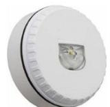
Flash led Solista LX pour montage mural, lumière blanche, base basse rouge, 9-60VDC, 10-25mA, IP65, conforme EN54-23, couverture flash C-3-7,5, fréquence 0,5 ou 1 Hz, dimensions D93mm x H38mm
