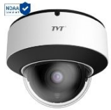
Outdoor vandal-proof dome motor lens 2.8-12mm • E3B-A • 12 MP (4000 x 3000) • IP • 0.006 Lux@F1.4 • AI: VSA 1.0 - VSA 2.0 (onderscheid tussen mens en voertuig) Tellen detectie-Menigtedichtheid detectie-Tampering Detectie-Metadatas • IR correctie motor lens 2.8-12mm f/1.4 • 96-46° • WDR 75dB@25 Bps • Infrarood tot 50m • H265-H264-MJPEG • 25 Beelden/sec. • IP67-IK10 • PoE: IEEE 802.3af Klasse 3 • Verbruik: max. 11W • Andere voeding: Vcc : 12 V +/-10 % • Temp: -30° C tot + 60° C • Audio: 1 ingang/uitgang en interne microfoon • Alarm: 1 ingang en 1 uitgang • SD card: 256 Gb max. • Onvif-NDAA-CVBS uit • Kleur: Wit •Diam: 141 x 100,2
