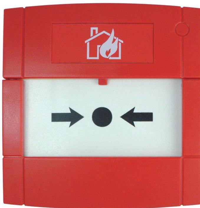
Les déclencheurs manuels d'incendie MPC1A, MCP3A et MCP4A sont installés aisément par le biais de connecteurs coulissants. Les déclencheurs répondent à EN54-11 et sont livrés avec une vitre flexible incassable. La vitre est repositionnée à l'aide de la clé de test. Il existe diverses configurations électriques. Le bouton a une fonction anti-sabotage. Dès que la vitre ou la face du bouton poussoir est enlevée, le bouton passe en état d'alarme.
