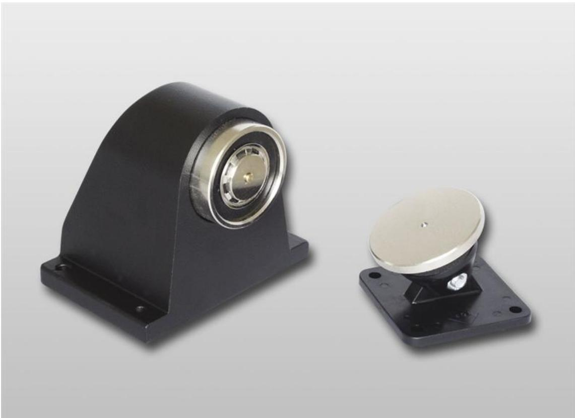
Les aimants de portes CSA maintiennent les portes ignifuges ouvertes pendant leur utilisation normale. En cas d'alarme incendie, les portes sont déverrouillées et fermées par une pompe, ce qui assure la résistance au feu du compartiment. Les aimants sont fréquemment utilisés dans des hôpitaux, maisons de repos, immeubles de bureaux, hôtels, écoles... où des portes ignifuges sont généralement présentes.
